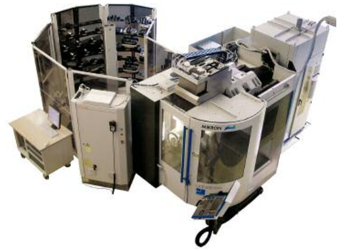
Die Bilfit AG produziert auf modernsten Maschinen – Im Bild eine 5-Achs-Fräsmaschine mit Roboter (System 3R)
